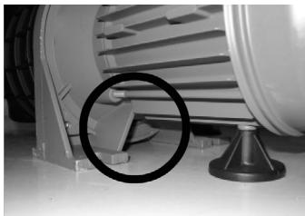
Contrôler régulièrement l'étanchéité! (Une fuite au niveau de la garniture mécanique peut provoquer des dommages importants!)
