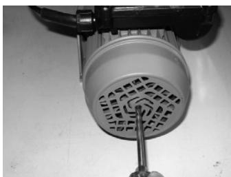
Vor Inbetriebnahme und längerem Stillstand die Achse durch den Lüfter drehen um Gleitringdichtungsperre zu verhindern.
